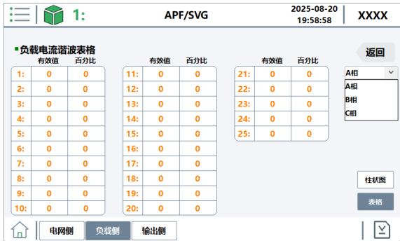
图 2-18 负载电流谐波表格
