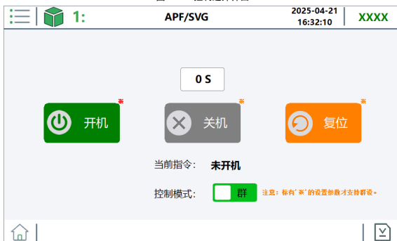
图 2-49 开关机操作界面（群控）
